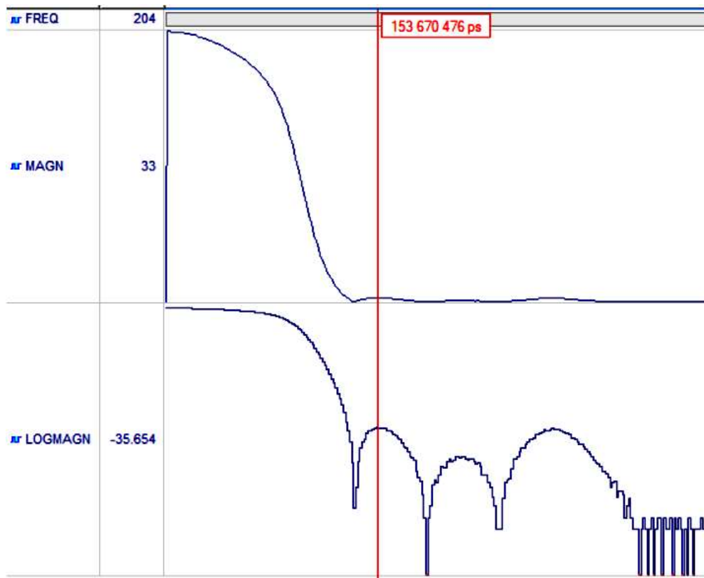
Рис. 18. АЧХ і логарифмічна АЧХ фільтра на рис. 17
